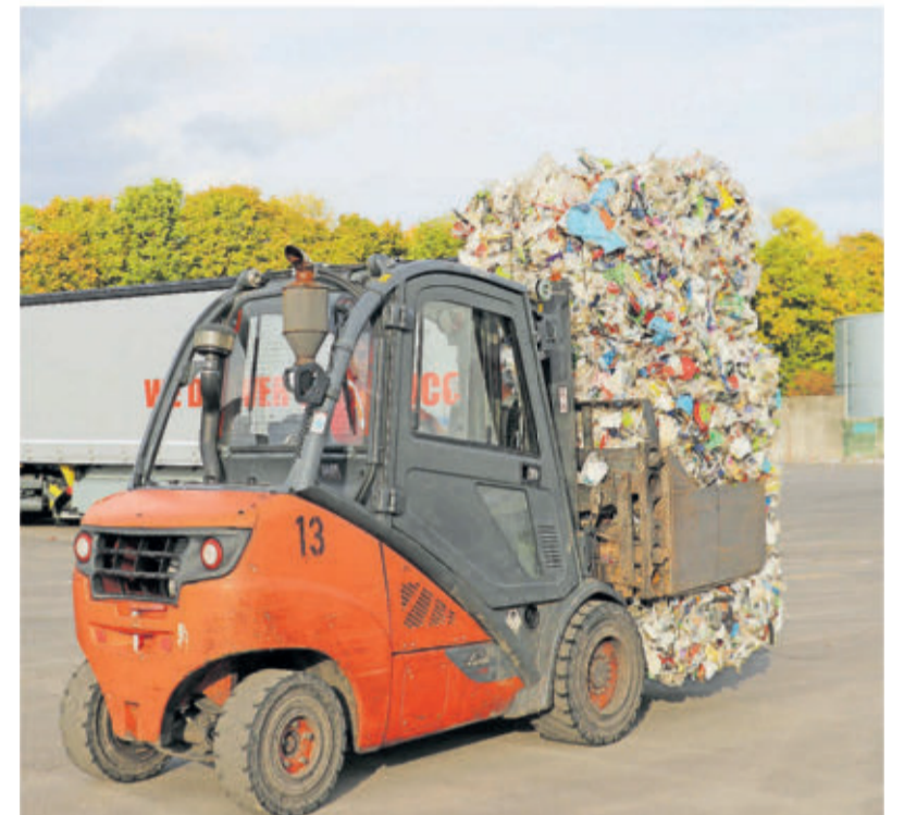
Hier werden gelbe Säcke angeliefert und von einem Hublader auf ein Band gefahren, wo sie in einem ersten Schritt aufgerissen werden.
