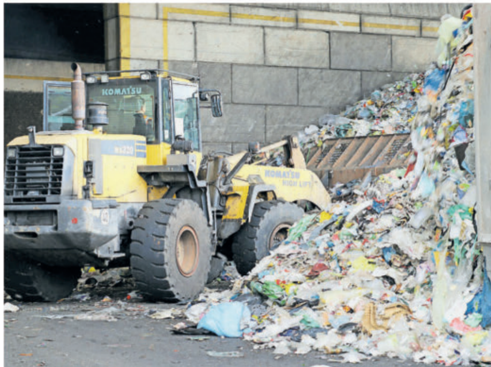
Hier werden gelbe Säcke angeliefert und von einem Hublader auf ein Band gefahren, wo sie in einem ersten Schritt aufgerissen werden.
